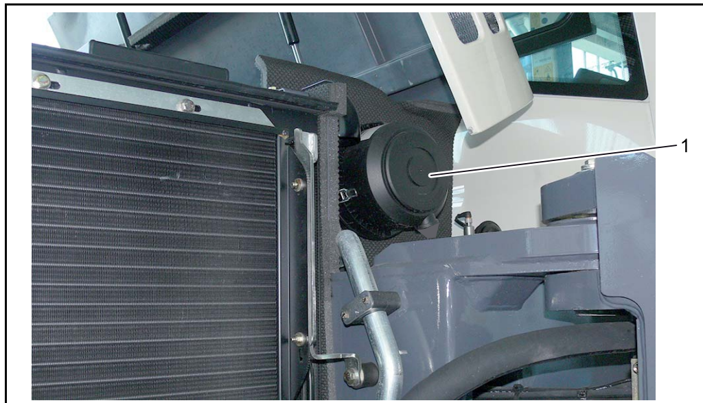
Fig. 6-9 Entretien du filtre à air
