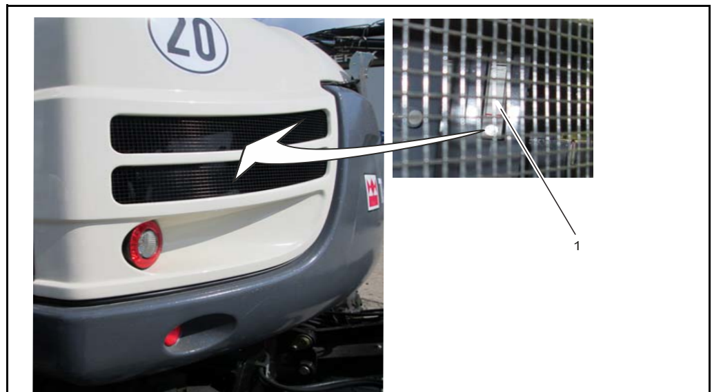
Fig. 6-25 Réservoir d'huile hydraulique - Regard
